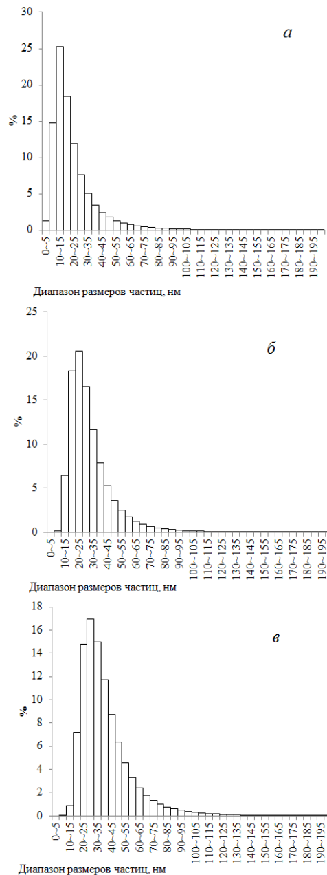
Рис. 61. Распределение частиц по размерам, по данным ДАС, для нанопорошков \text{Al}_2\text{O}_3 №№: 2 ( a ), 9 ( б ) и 10 ( в ) (нумерация Таблицы 5).
